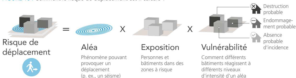
FIGURE 18 : Comment le risque de déplacement est-il calculé ?
